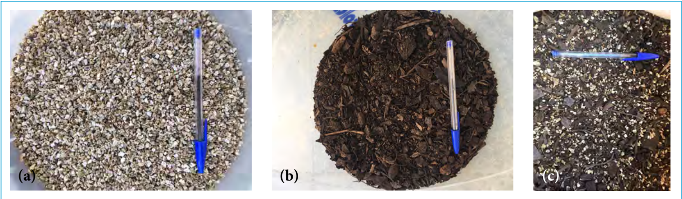
Figura 6 - Material de enchimento dos biofiltros: (a) vermiculita; (b) composto orgânico; (c) mistura composta por 60% de composto orgânico e 40% de vermiculita.
