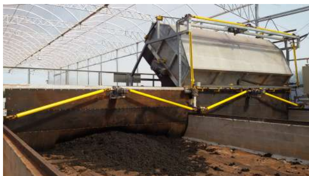
Figura 2 – Sistema de secagem e compostagem em estufa, ETE Lageado, Botucatu, SP.
