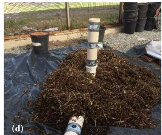
Figura 5 – Detalhe da montagem das pilhas de compostagem naturalmente aerada utilizando tubo T perfurado (a) e vista das pilhas formadas (b). Experimento piloto conduzido durante vigência do INCT ETEs Sustentáveis (c e d) (medidas expressas em metros).
