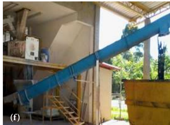
Figura 3 – Alternativas de homogeneização do lodo com a cal: (a) manual; (b) betoneira; (c) maromba; (d) enxada rotativa; (e) retroescavadeira; (f) misturador mecânico horizontal (eixo central e pás do tipo arado com tempo de detenção mínimo de 3 minutos).
