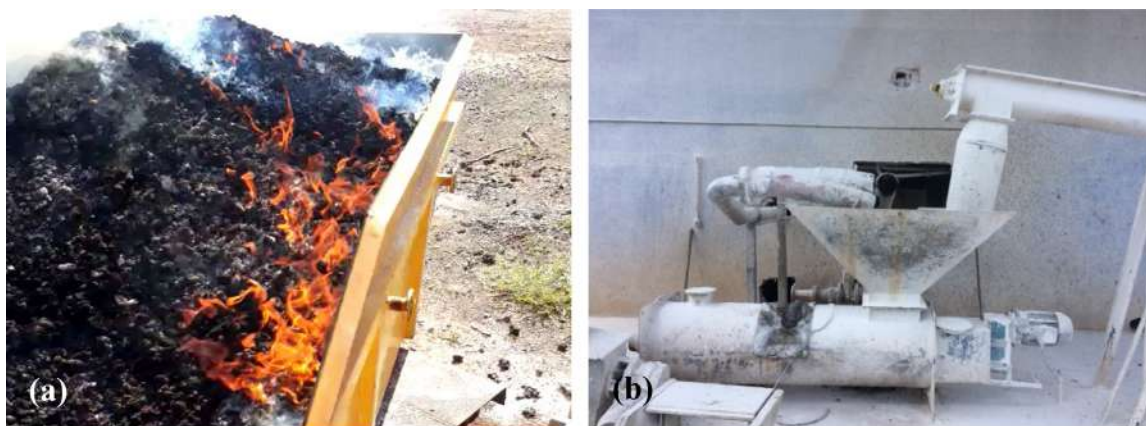
Figura 6 – Problemas encontrados durante o processo de EA: (a) combustão do lodo misturado com a cal e (b) elevada liberação de poeiras.
