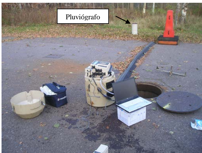
Figura 2: Amostrador automático instalado no poço de visita à juzante da bacia de drenagem e ao fundo o pluviôgrafo
