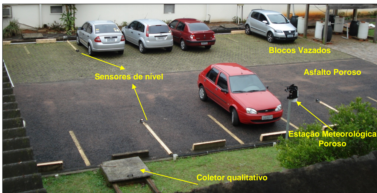
Figura 1: Pavimento permeável instalado no Instituto de Pesquisas Hidráulicas/UFRGS.
