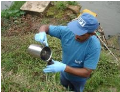
Figura 5. Amostragem de água superficial com jarra de inox.
