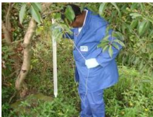
Figura 3. Amostragem com bailer.
