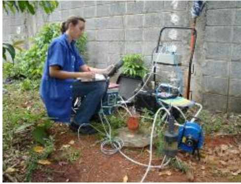
Figura 4. Amostragem com bomba de baixa vazão.
