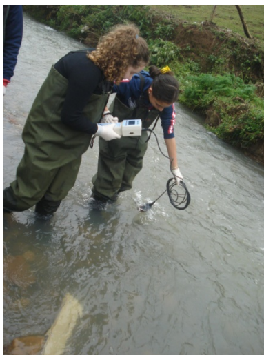
Figura 4 - Coleta de amostras e análise da qualidade da água do Arroio Pena Branca - julho/2015
