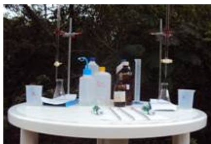
Figura 4 – Reagentes, vidrarias e utensílios utilizados na titulação das soluções de NaOH provenientes das câmaras estáticas instaladas no campo.
