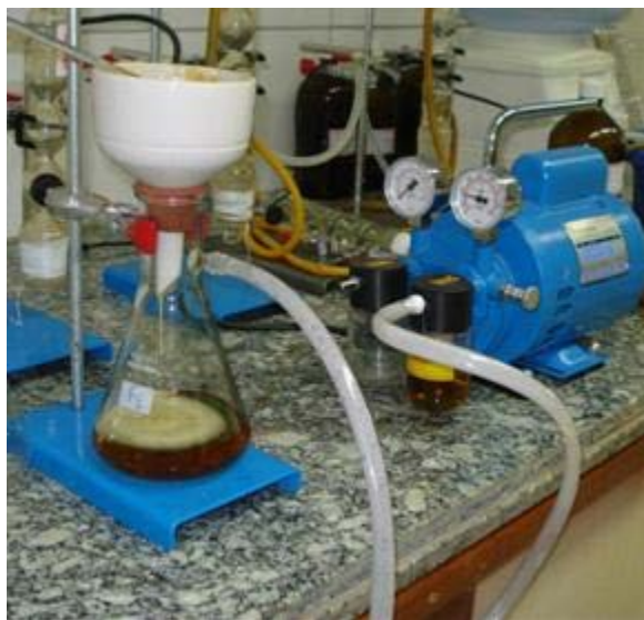
Figura 01. Mecanismo de filtração a vácuo (Funil de Buchner e compressor).
