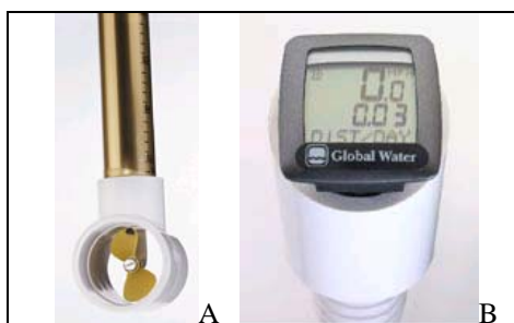
Figura 2: (A) Haste e hélice para medição de fluxo de água. (B) Marcador digital
