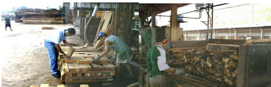
Figura 2 - cubagem dos destopos e volume da caixa coletora.
