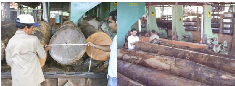
Figura 1 - Determinação da medida da tora.
