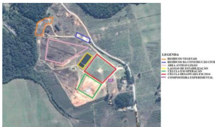
Figura 2 - Aterro Sanitário do Município da Lapa-PR: Composição da estrutura operacional Fonte: Autores (2016).
