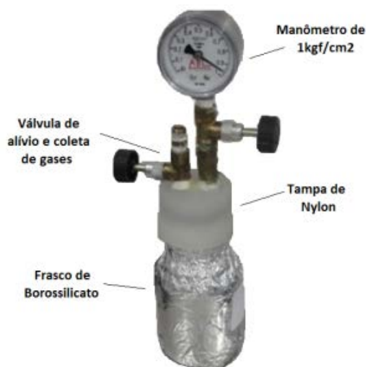
Figura 1. Biorreatores utilizados para a realização do ensaio BMP
