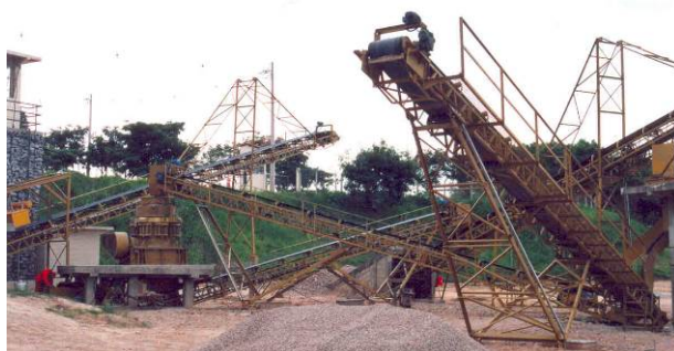
Figura 2 - Conjunto de esteiras e britador da Unidade de Reciclagem de RCC
