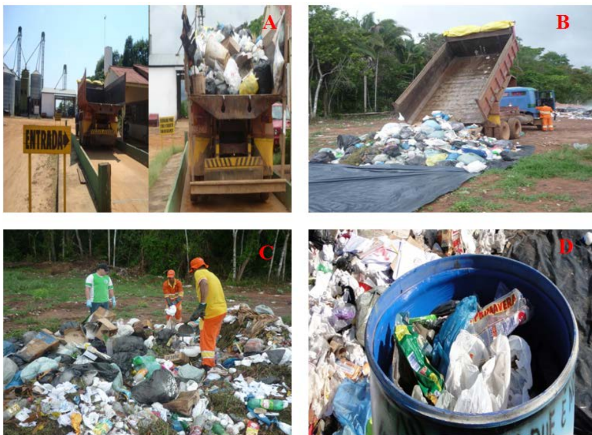
Figura 1. Procedimento para determinação da quantidade e composição gravimétrica dos RSU. A) Pesagem do caminhão vazio e com RSU. B) Descarregamento dos resíduos sólidos na lona. C) Reviramento dos resíduos sólidos para o quarteamento. D) Pesagem dos materiais para determinar da composição gravimétrica.
