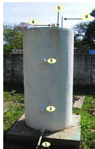
Figura 1. A) Corte da célula experimental (Lisímetro) e equipamentos de instrumentação. 1. Tubo de drenagem, 2 e 3. Tubo de coleta de sólidos, 4. Dreno de gás, 5. Piezômetro, 6. Placa de recalque. B) Foto do Lisímetro instalado.
