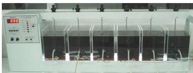
Figura 4. Jar Test utilizado nos ensaios de precipitação química.
