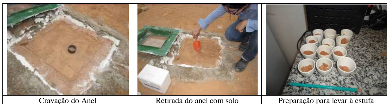
Figura 3: Ensaio - Anel de amostragem.
