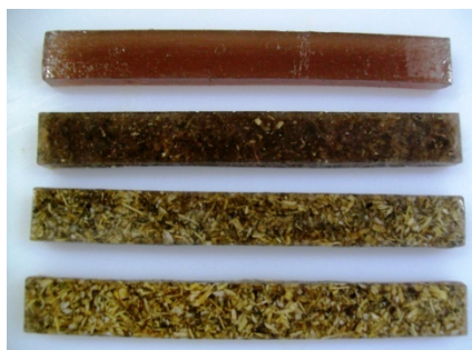
Figura 4: Corpos de prova produzidos com resina pura, 5, 10 e 15% de Girassol
