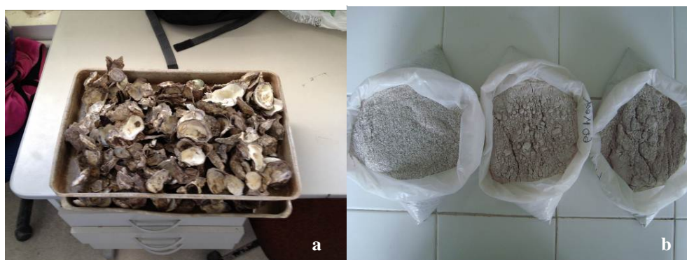
Figura 1: Fotos das conchas de ostra: sem trituração (a) e triturada com granulometria de 20, 60 e 100 mesh, respectivamente (b).
