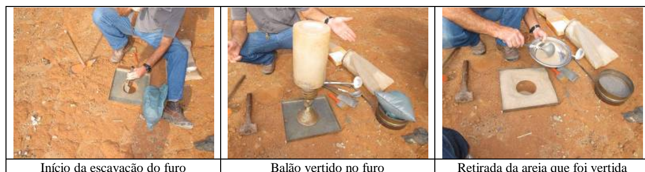
Figura 4: Ensaio - Frasco de areia.
