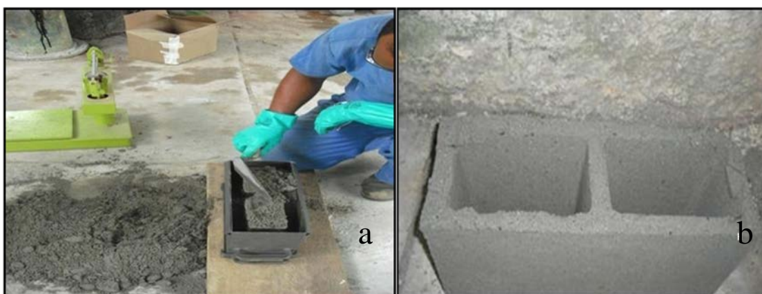
Figura 4- Colocação da argamassa na forma (a) e bloco pronto (b)
