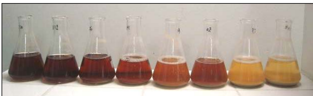
Figura 5: lixiviado após o estudo preliminar com o adsorvente calcinado a 1000°C durante 3 horas com diferentes massas (0,5 a 10g) de adsorvente.
