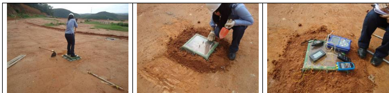
Figura 2: Detalhe da instalação e Leitura da Placa de Fluxo.
