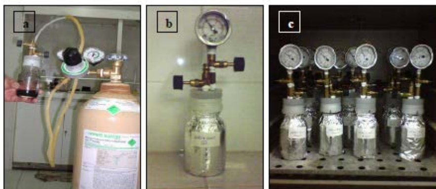
Figura 01. Etapas seguintes do ensaio BMP: (a) recirculação de nitrogênio nos frascos; (b) fechamento do frasco e colocação do manômetro; (c) frascos incubados (ALVES, 2008).
