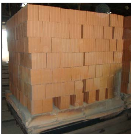
Figura 4.12. Tijolos Fabricados com a Adição do Resíduo Lama do Hidrofiltro.
