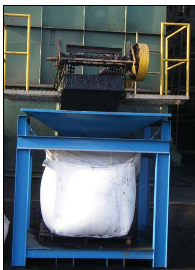
Figura 4.11. Processo de Secagem da Lama do Hidrofiltro.
