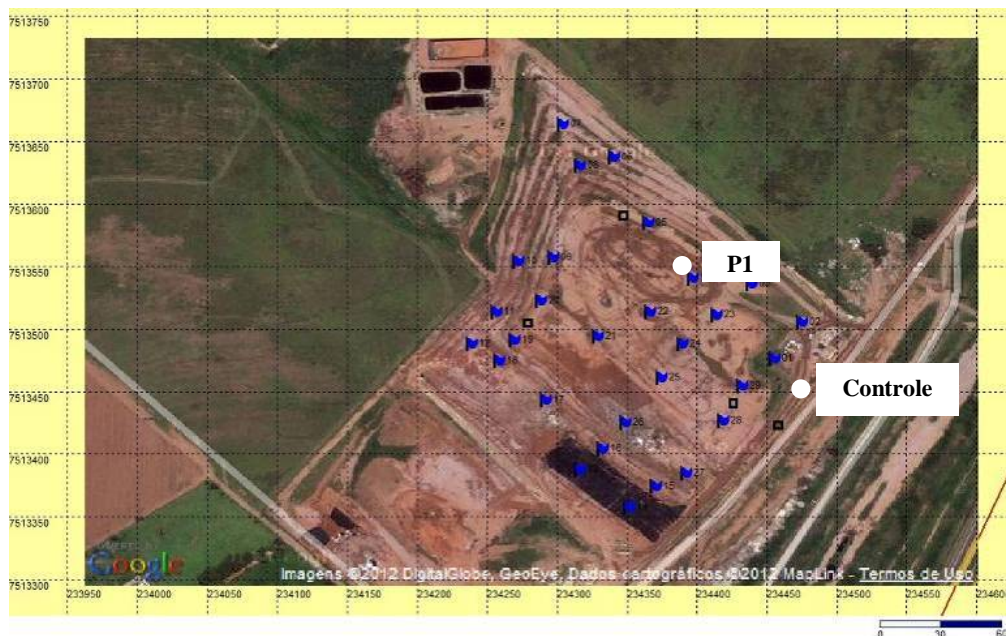
Figura 2- Localização dos pontos P1 e Controle onde foram instaladas as termoresistências para aferição da temperatura, no aterro sanitário de Rio Claro-SP
