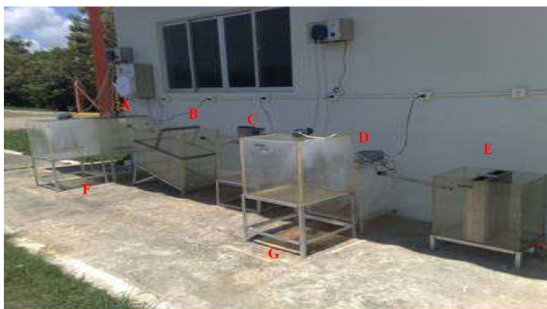
Figura 1. Vista do sistema completo: (A) Precipitação química, (B) Decantação, (C) Stripping de amônia com agitação superficial, (D) Correção do pH, (E) Barreira reativa, (F) Caixa de mistura do leite de cal, (G) Caixa de mistura para ácido e água. FONTE: Lins (2011)
