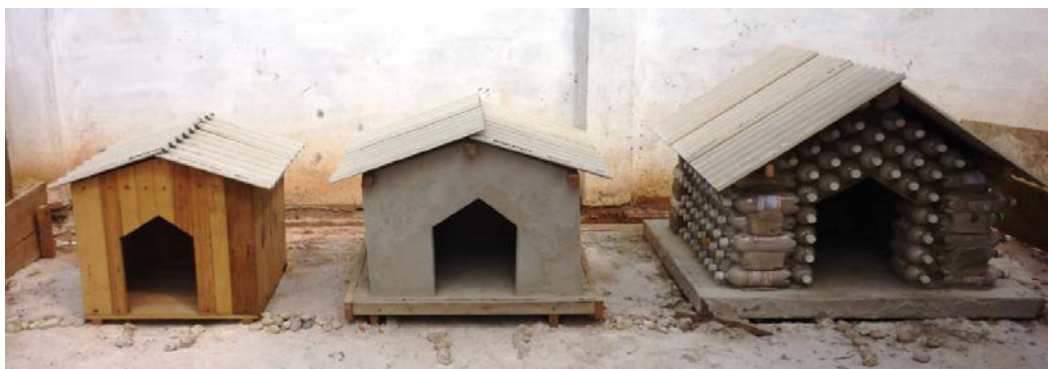
Figura 4– Disposição dos protótipos para avaliação do conforto ambiental Fonte: Dados da pesquisa
