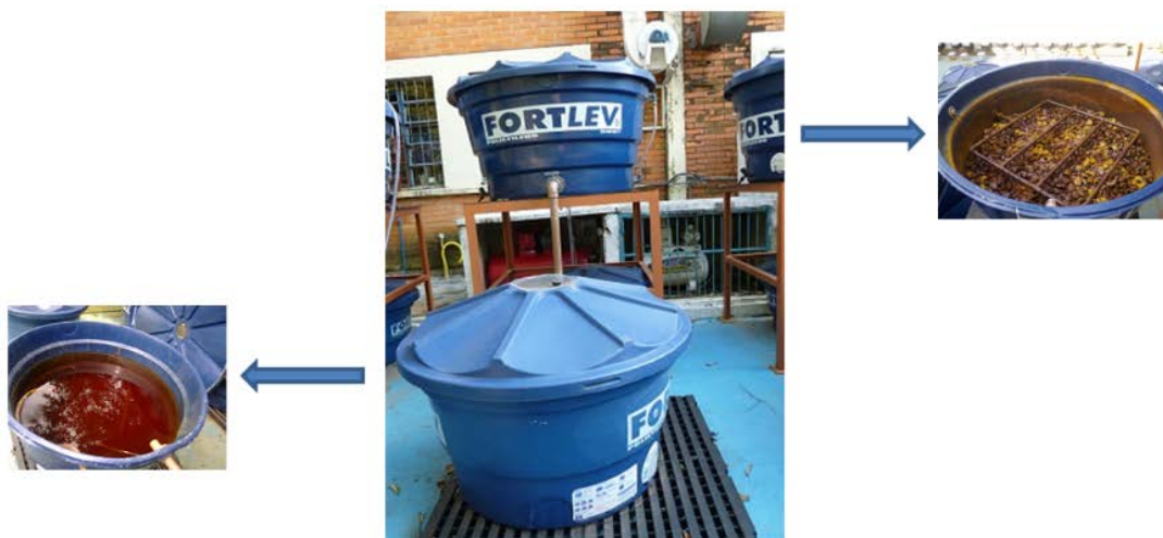
Figura 2: Planta piloto para lixiviação do rejeito piritoso e produção de sulfato ferroso.
