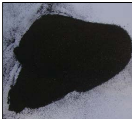
Figura 4.2. Característica Física do Resíduo do Pó da Regeneração da Areia de Moldagem.
