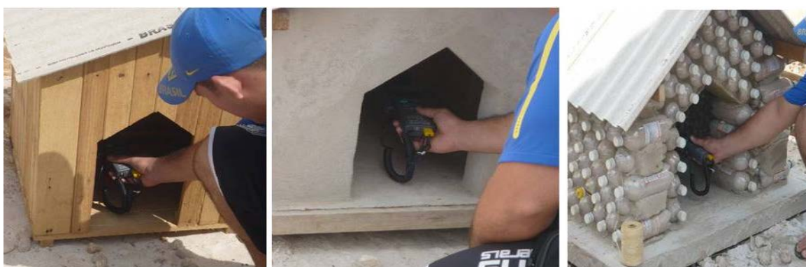
Figura 5 – Coleta de Dados de Ruído dos Protótipos Fonte: Dados da Pesquisa
