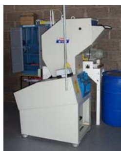
Figura 3 – Moinho de facas utilizado na moagem do material.
