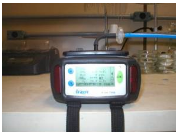
Figura 4. Sistema de coleta e análise dos gases em medidor portátil XAM-7000 Dräger
