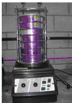
Figura 1 – Sistema de peneiras para distribuição granulométrica do farelo de girassol.
