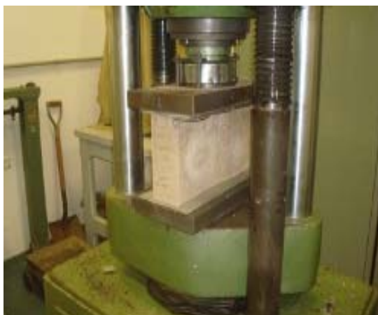
Figura 4 – Bloco moldado e capeado na prensa para ensaio de resistência à compressão
