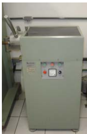
Figura 2 – Misturador de câmara fechada MH 100.
