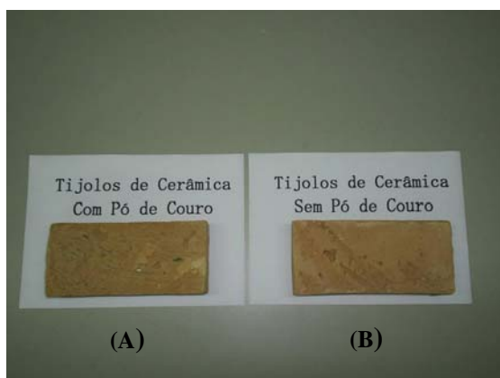
Figura 3: Amostras de tijolos (A) com e (B) sem pó de couro
