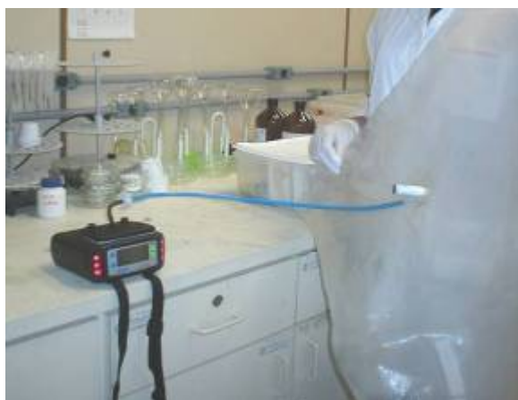
Figura 4. Sistema de coleta e análise dos gases em medidor portátil XAM-7000 Dräger
