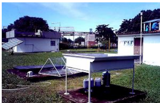
Figura 4 – Foto do evaporador instalado na área de testes do grupo FAE/DEN/UFPE.
