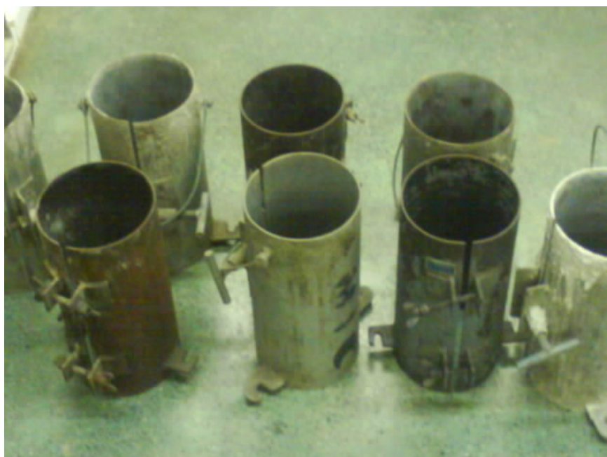
Figura 1. Molde dos corpos de prova.
