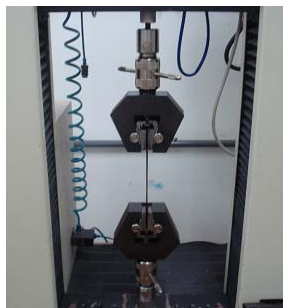
Figura 6 – Realização do ensaio de tração.
