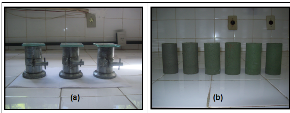
Figura 1 - Molde cilíndrico utilizado e corpos de prova preparados
