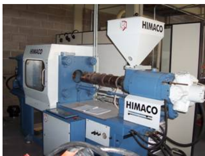
Figura 4 – Máquina injetora utilizada na confecção dos corpos de prova.
