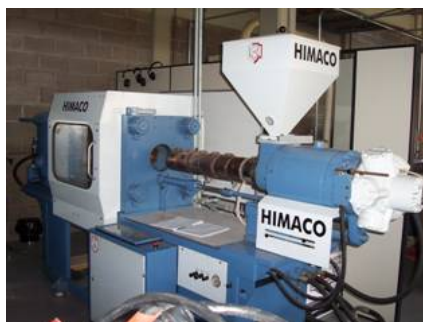
Figura 5 – Máquina injetora utilizada na confecção dos corpos de prova.
