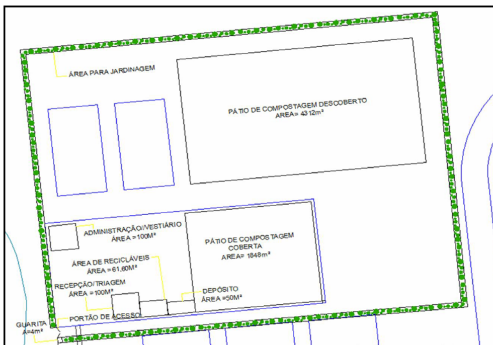
Figura 6 – Layout da área de transbordo e triagem, acoplado por uma unidade de compostagem.
