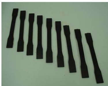
Figura 5 – Corpos de prova para ensaio de tração do compósito.
