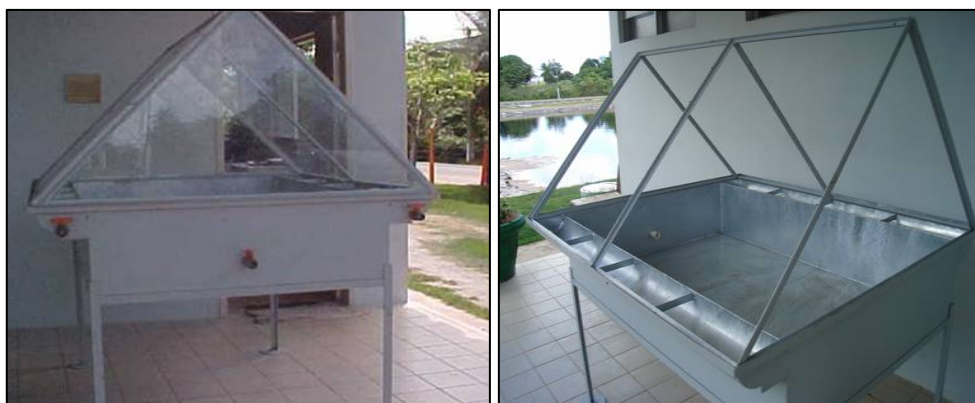
Figura 3 – Visão frontal do destilador e dos dispositivos de coleta (a) e Vista das calhas onde é feita a coleta da água destilada (b)
