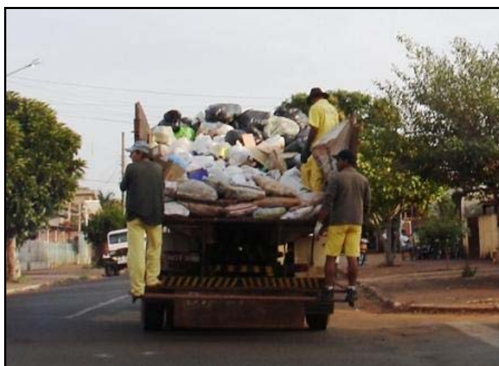
Figura 1: Transporte dos resíduos urbanos. Observa-se a facilidade do derramamento de lixo apresentada por este tipo de caminhão e também a falta de proteção oferecida aos garis, como a falta do uso de roupas e EPIs adequadas pelos mesmos para este tipo de trabalho.
