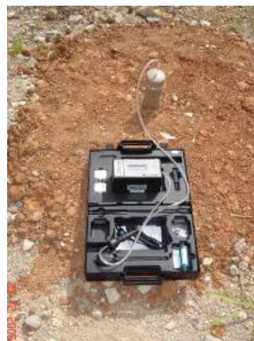
Figura 4 – Realização de leitura direta nos drenos de biogás
