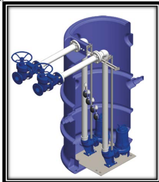
Figura 01: Unidade de Transferência vista em corte.
