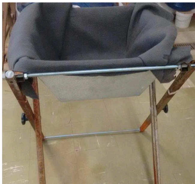
Figura 1: Leito de Drenagem em escala reduzida com cobertura por manta geotêxtil.
