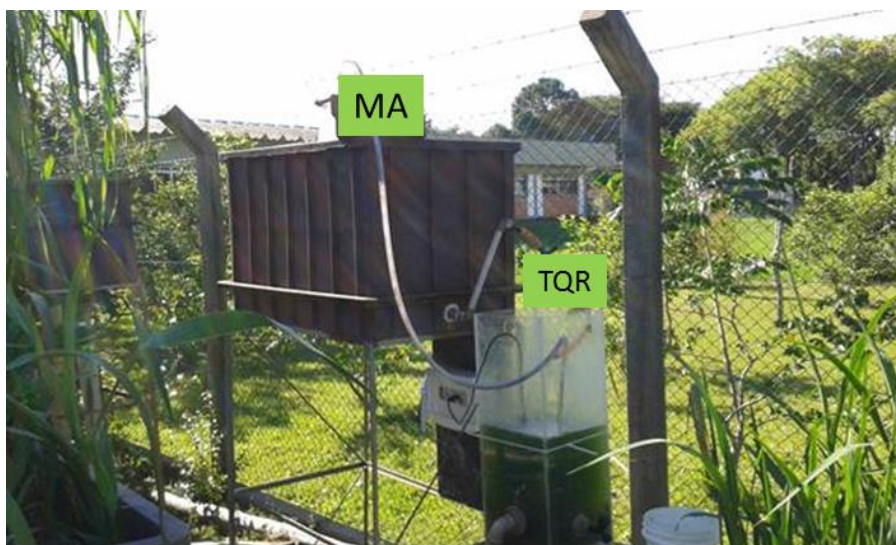
Figura 3: Detalhe do sistema de MA com recirculação externa em reator tipo coluna com volume útil de 20 L. TQR – Tanque de Recirculação. CONFIGURAÇÃO 1.
