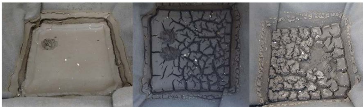
Figura 7: Aspecto do lodo desaguado após 1, 2 e 3 dias de ensaio para a manta de 400g/m 2 .
