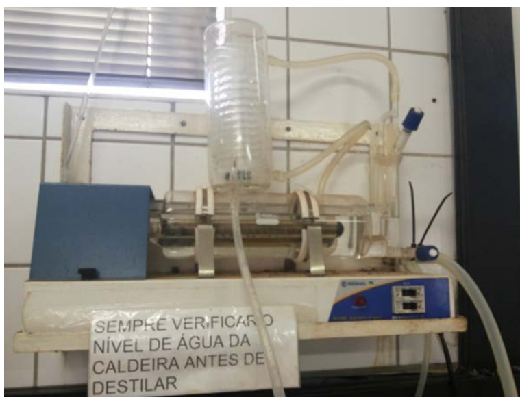
Figura 1: Destilador modelo TE – 1782, utilizado para o processo de destilação de água.
