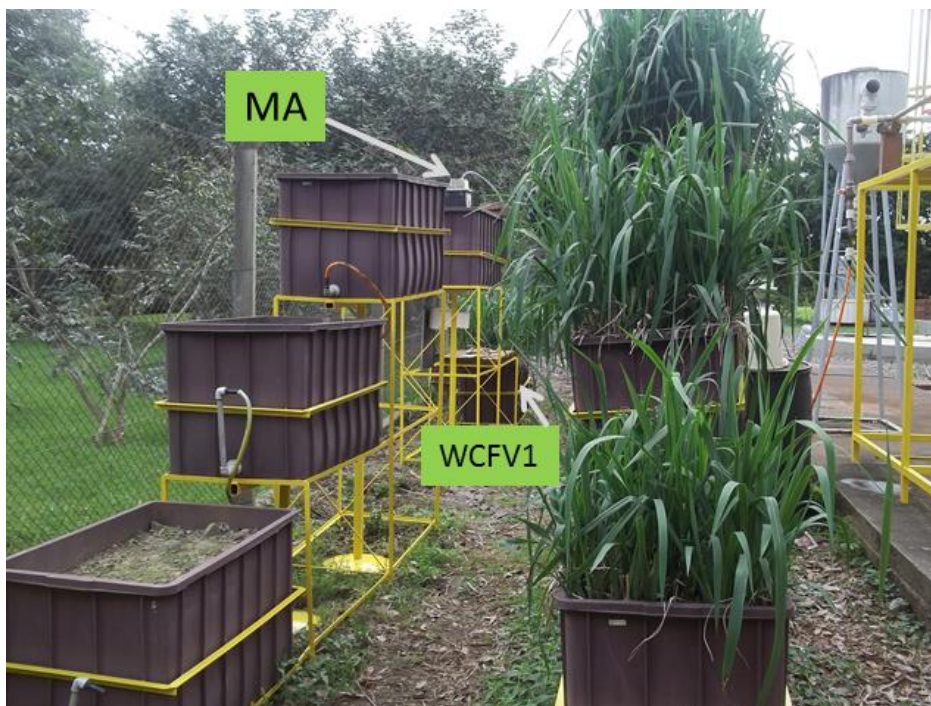
Figura 5.: Detalhe do sistema de MA sem recirculação externa em reator tipo coluna na CONFIGURAÇÃO 2.
