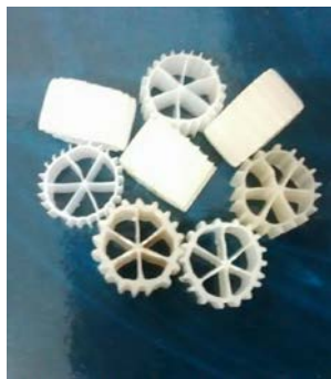
Figura 1 - Peças de polipropileno utilizadas como suporte (biomídias).
