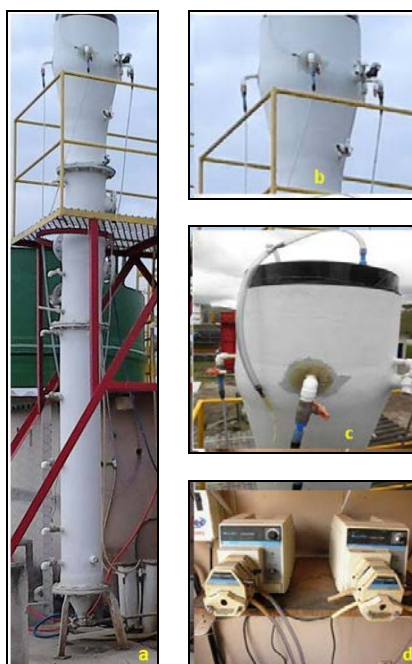
Figura 1. Stripping na zona de decantação. a-R3; b-pontos de distribuição da vazão de ar; c-ponto de coleta do gás H_2S ; d- bombas de ar.
