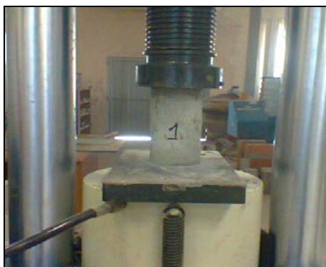
Figura 3: Ensaio de compressão axial
