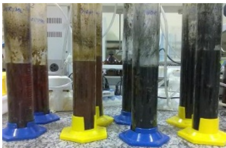
Figura 1: Testes operando em sistema aeróbio de batelada
