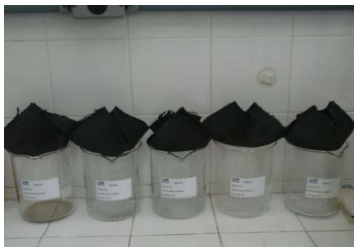
Figura 2: Ensaio de remoção de sólidos com diferentes aberturas aparentes do geotêxtil
