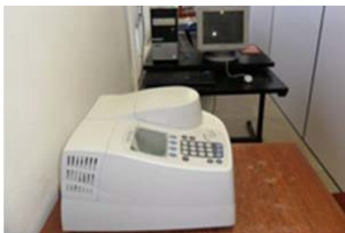
Figura 2: Espectrofotômetro UV-visível Thermo Genius 10TM (Watham, MA – EUA).
