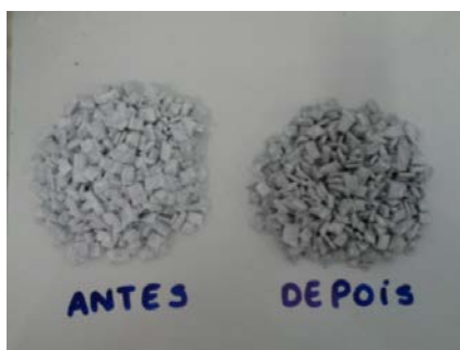
Figura 3 – Cobertura do dióxido de titânio em alumínio antes e depois das corridas no reator.
