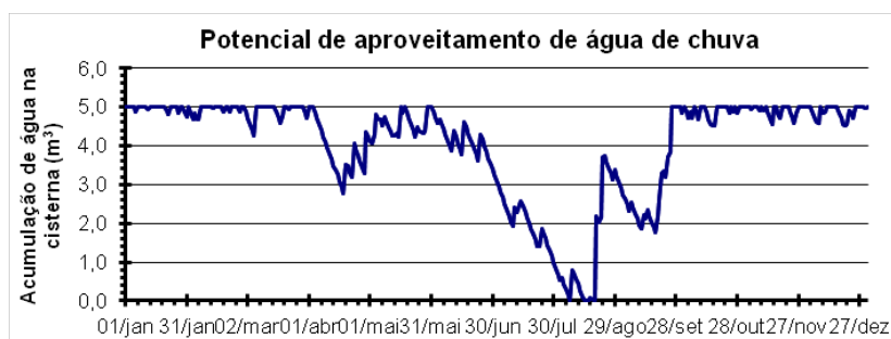
Figura 4: Previsão de acumulação de água na cisterna durante as diferentes estações do ano.
