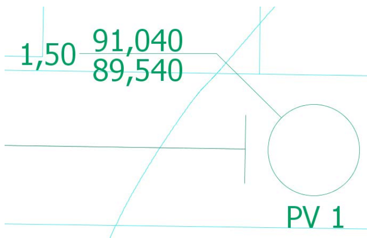
Figura 5: Exemplo de poço de visita num tubo com ponta seca.
