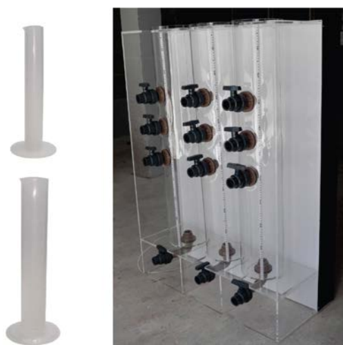
Figura 2- Colunas de sedimentação utilizadas nos ensaios: (a) provetas de 1L e 2L (b) colunas de sedimentação 30L
