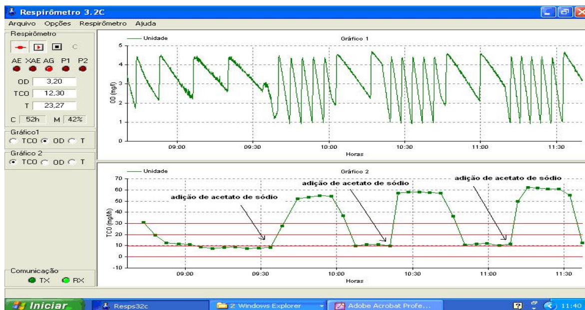
Figura 2: Teste respirométrico com 3 adições de acetato de sódio (correspondendo cada adição a 60 mgDQO/L) em que foram construídas três curvas da taxa de consumo de oxigênio (software S32c).
