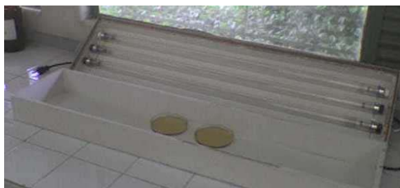
Figura 2 – Reator com lâmpadas UV-C.
