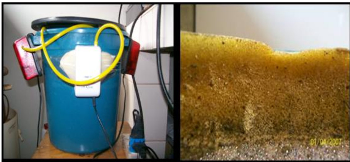
Figura 3. Vista lateral do reator (a); detalhe da espuma de poliuretano (b).
