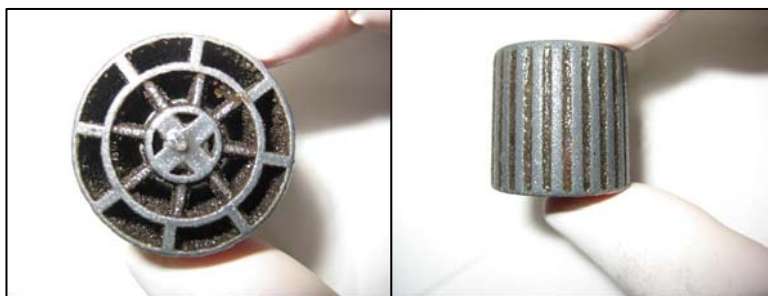
Figura 4: Biomassa aderida ao meio suporte utilizado
