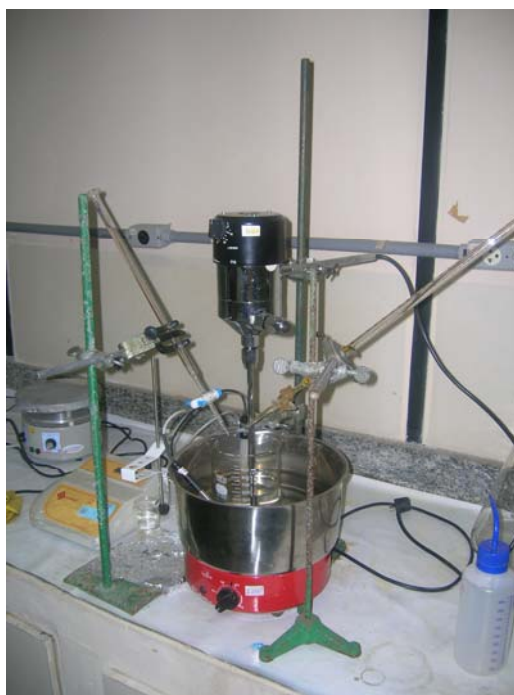
Figura 1: Aparato experimental utilizado para avaliação de remoção de selênio
