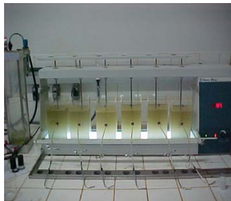
Figura 2 – Ilustração da desinfecção utilizando o equipamento para ensaio de JAR TEST.
