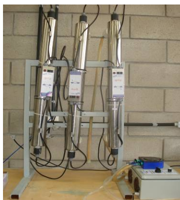
Figura 3: Sistema de desinfecção por UV
