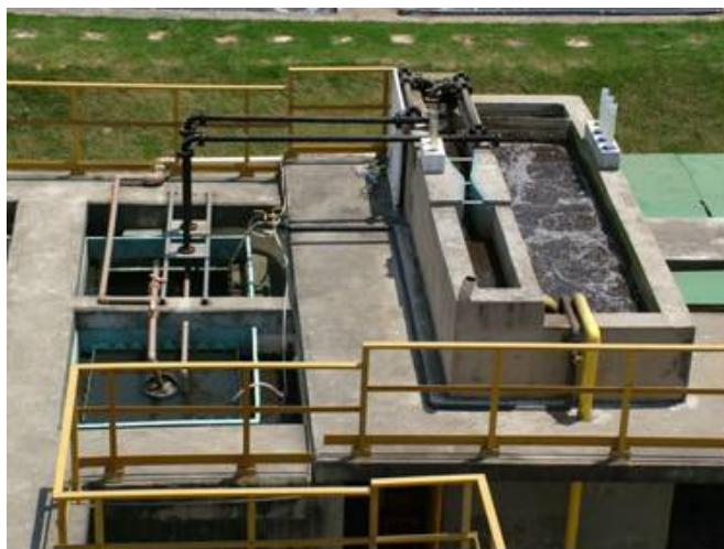
Figura 2: Unidade experimental MBBR
