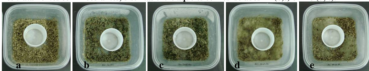
Figura 2: Reatores respirométricos aos 20 dias de experimento: a = óleo de soja (controle), b = óleo de soja + isolado F2 ( Penicillium sp.), c = óleo de fritura + F2, d = escuma de esgoto sanitário + F18 ( Rhizomucor sp.), e = escuma de caixa de gordura RU-UFES + F18). Biomassa fúngica pode ser vista nos tratamentos com inoculantes, distintas entre aqueles com os isolados F2 (b,c) e F18 (d, e).
