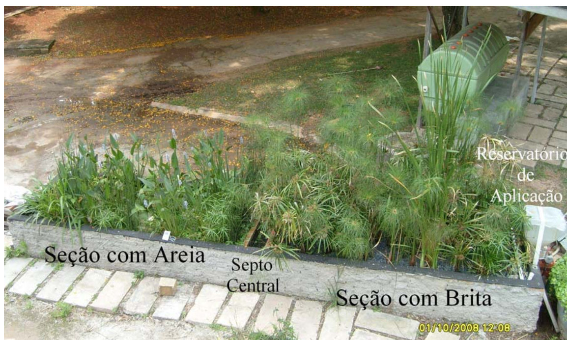
Figura 1: Célula de wetlands, mostrando a seção com areia, septo central, seção com brita nº1 e reservatório de aplicação.
