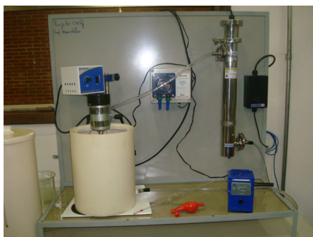
Figura 1 Imagem do Sistema Utilizado no Tratamento combinado com radiação Ultravioleta
