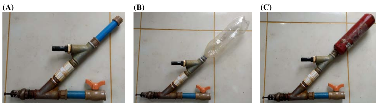
Figura 2. Inclinação de campânula de 45° utilizando: (a) PVC, (b) PET e (c) cilindro de extintor de incêndio.
