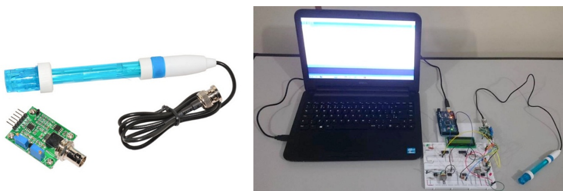
Figura 1 - Sensor de pH Sindax SEN0161 – Sonda e placa de circuito eletrônico ligadas ao circuito prático e a um computador portátil. Fonte: Elaborada pelo autor (2017).
