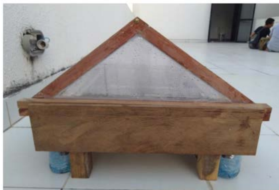
Figura 1 - Vista frontal do sistema de destilação solar
