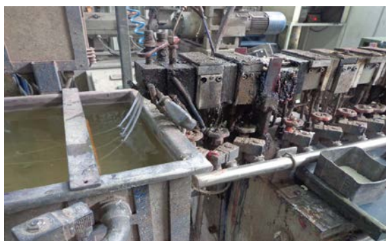
Figura 3: Produção por extrusão da poliamida 66 suportadas com ZnNPs.
