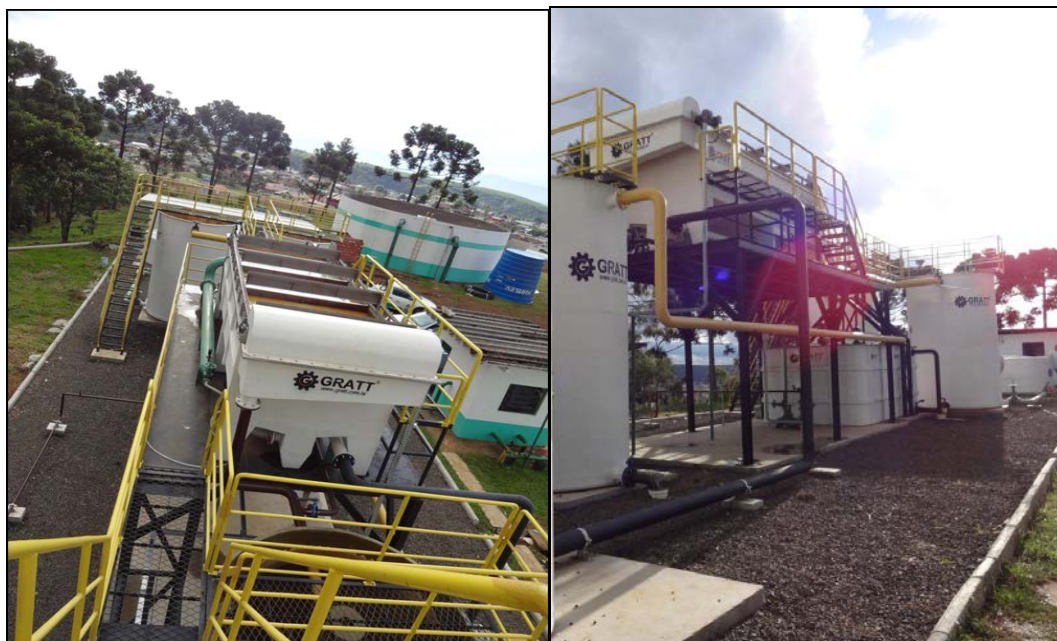
Figuras 07 e 08 – Estação de Tratamento de Água Compacta Metálica com a unidade de Flotação.
