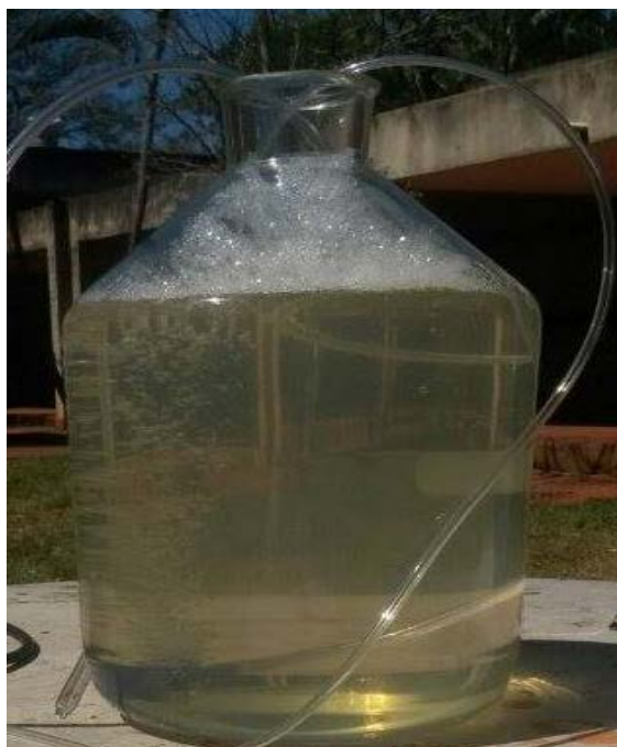
Figura 3: Reator em Batelada.
