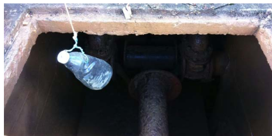
Figura 6 - Coleta do lodo.
