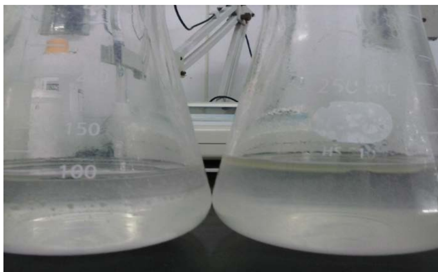
Figura 1: Comparação dos efluentes, criados em laboratório, sem aplicação da substância péctica (à esquerda) e com aplicação (à direita).
