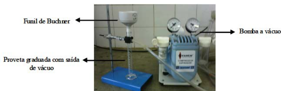
Figura 1: Equipamentos e materiais utilizados no teste de resistência específica.
