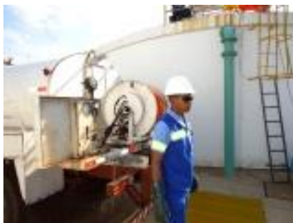
Foto 1 – Caminhão Serv-jet com vazão de 130 l/m.
