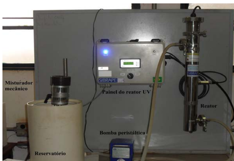
Figura 1 Imagem do Sistema utilizado nos ensaios em ciclo contínuo
