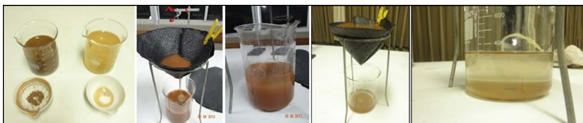
Figura 1: Amostras ensaiadas, ensaio de cone, e clarificado da amostra de lodo, respectivamente.
