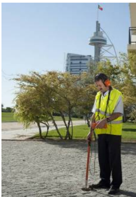
Figura 3 – Detecção Acústica de Fugas
