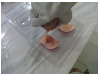
Foto5: Fabricação de sabonetes a base de glicerina sólida em laboratório. Fonte: Os autores
