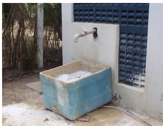
Figura 3 – Resíduo gerado no processo de preparo da solução clorada a base de hipoclorito de cálcio.
