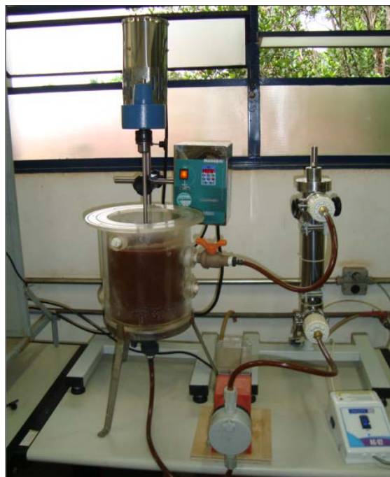
Figura1. Reator de bancada, equipado com agitação mecânica, bomba para circulação do lixiviado tipo diafragma e um esterilizado com lâmpada UV 15 W de potência utilizado no experimento.
