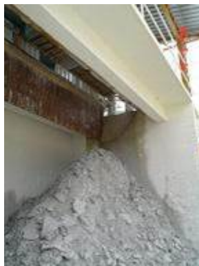
Figura 3: LBRO submetida à desidratação por filtro prensa (umidade inferior a 30%).
