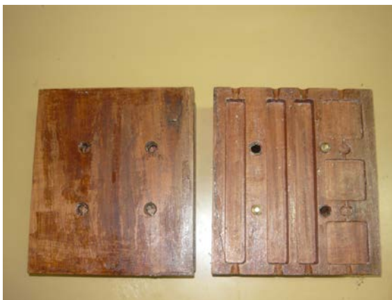
Figura 1 - Molde tipo macho-fêmea utilizado na elaboração dos corpos de prova.
