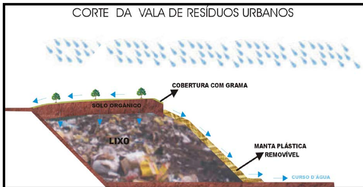
Figura 2 - Esquema de utilização da manta
