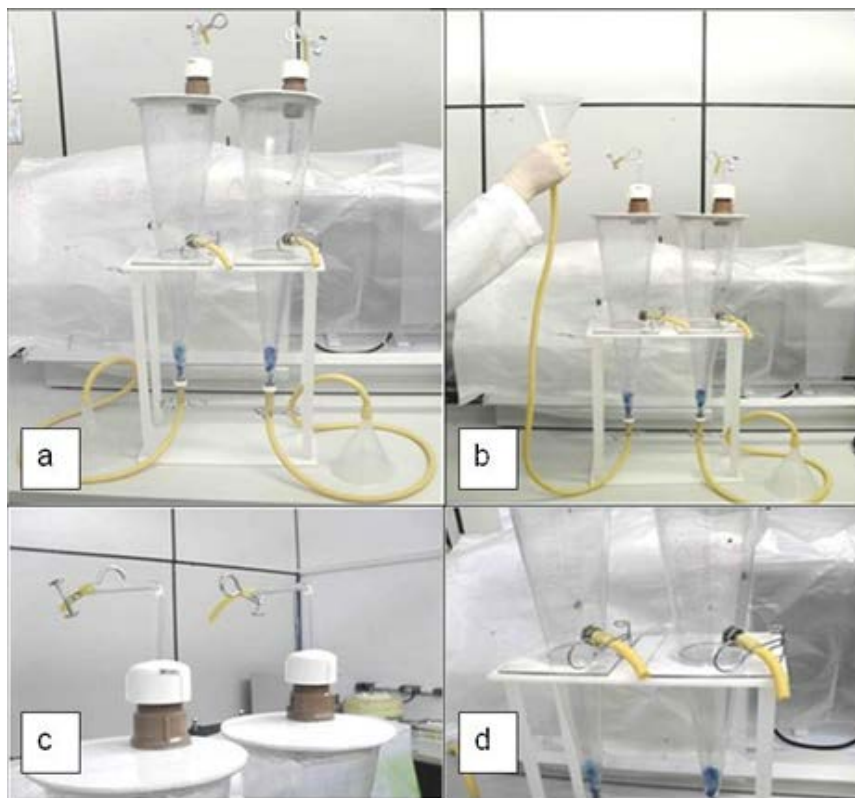
Figura 1: Reatores em batelada: a) visão geral, b) funil de alimentação, c) cap e tubo em “L”, d) saída do lodo
