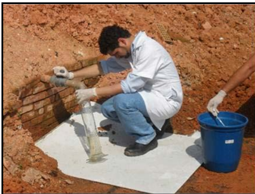
Figura 3: Coleta da amostra de lixiviado
