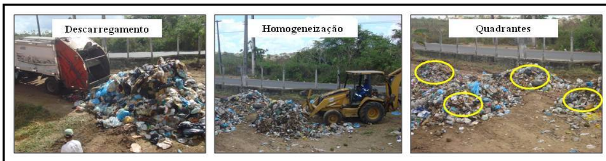
Figura 1. Descarregamento, homogeneização do material e divisão das pilhas
