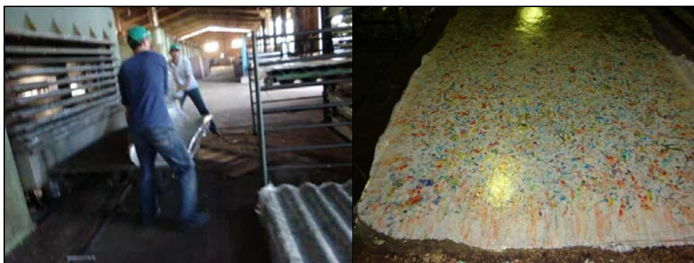
Figura 3: Uma das telhas fabricadas sendo levada até a prensa.
