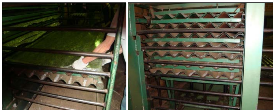
Figura 4: Esfriamento e moldagem das telhas.
