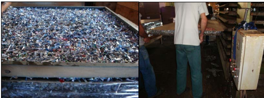
Figura 2: Materiais prontos para serem colocados na prensa (esquerda) e uma das telhas fabricadas sendo levada até a prensa (direita).
