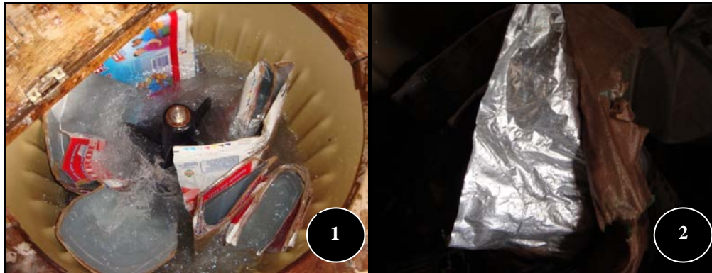
Figura 1: Processo de separação dos componentes das embalagens Tetra Pak.
