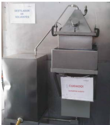
Figura III: Destilador desenvolvido para a finalidade de reciclagem do solvente.
