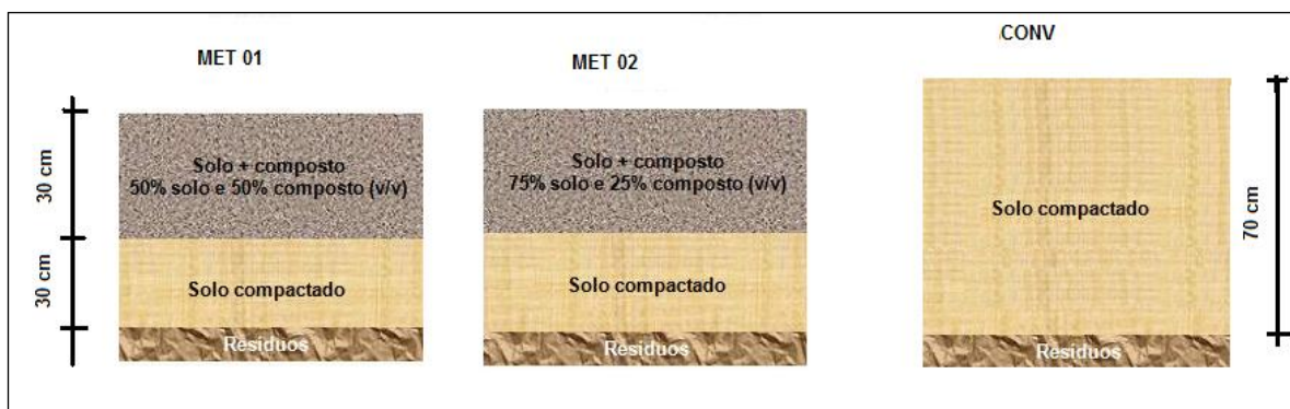
Figura 01: perfis das camadas de cobertura.
