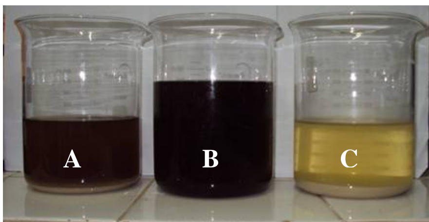
Figura 9 - Foto do lixiviado bruto (B) e após tratamento com 50mg/L (A) e 200 mg/L (C) de cal.
