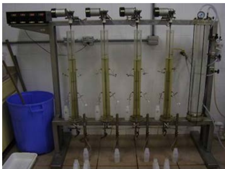
Figura 2–Fotografia do Equipamento de Flotatestes desenvolvido no Departamento de Hidráulica e Saneamento da Escola de Engenharia de São Carlos – SP e unidades de filtração em areia acopladas às câmaras de floculação/flotação.
