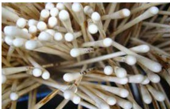
Figura 2: Membranas de ultrafiltração de fibra oca utilizadas no Piloto de MBR terciário.
