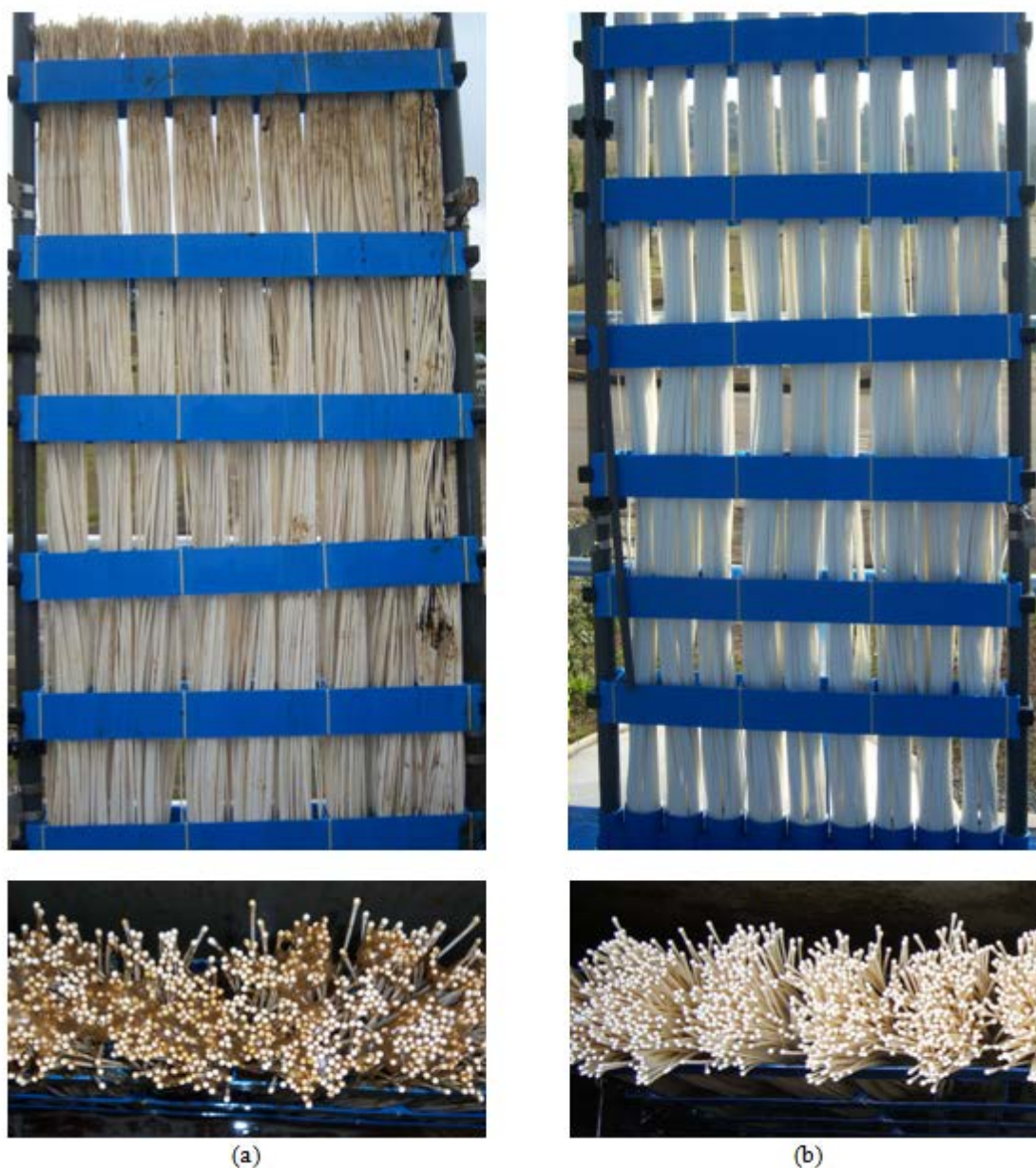
Figura 8: Módulo Piloto de membranas de fibra oca de ultrafiltração no momento de desativação do teste, após 9 meses de operação, antes (a) e após (b) a limpeza de recuperação.
