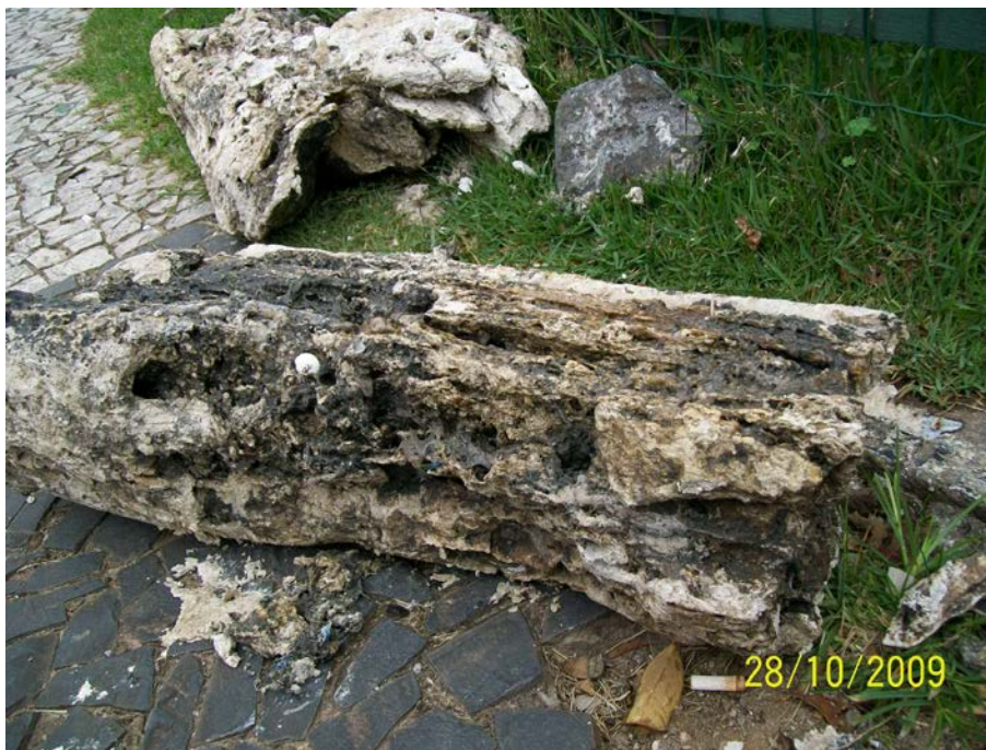
Figura 2: Gordura retirada da rede de esgoto.
