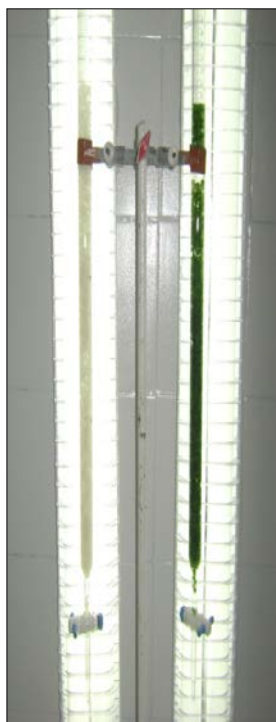
Figura 2: Bioreatores- microalgas e controle.
