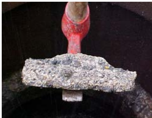
Figura 7 – Placa de gordura retirada da rede coletora de esgoto
