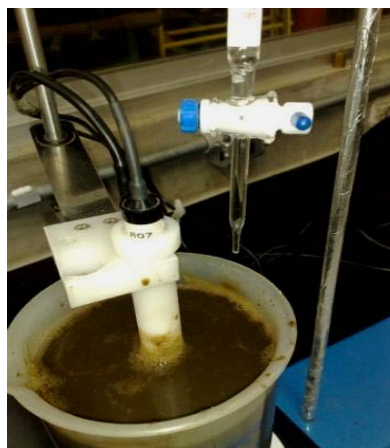
Figura 3 – Vista geral da aparelhagem montada para adição de água clorada e determinação de pH
