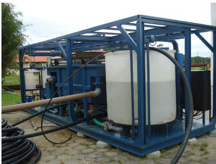
Figura 2: Vista da unidade Piloto de FAD.
