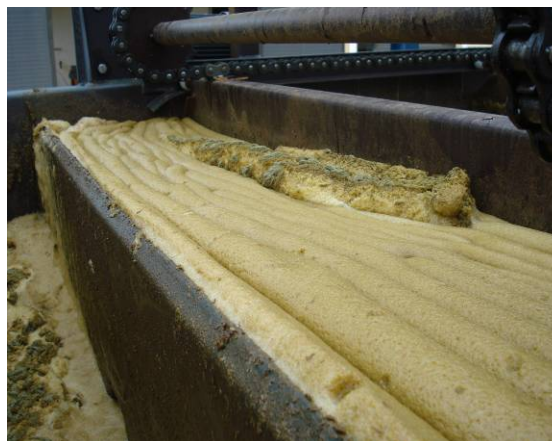
Figura 3: água coagulada submetida à flotação e o lodo formado na unidade Piloto.
