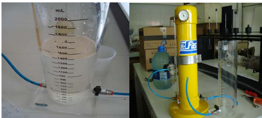
Figura 1: Flotador Piloto de bancada.
