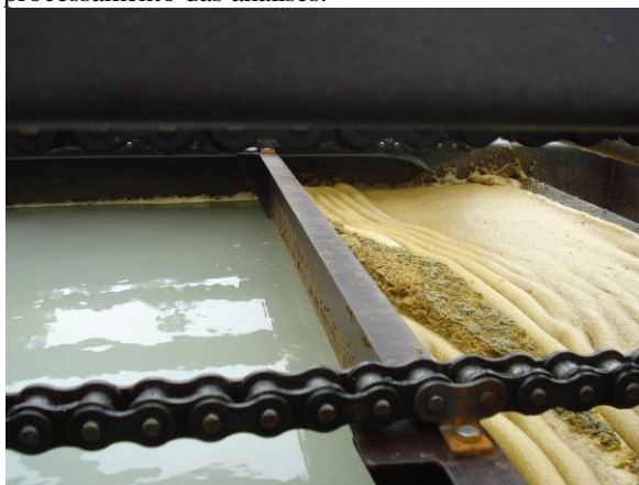
Figura 3: água coagulada submetida à flotação e o lodo formado na unidade Piloto.
