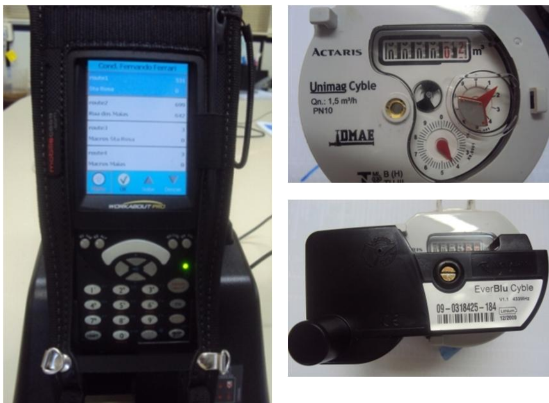
Figura 4: Os equipamentos utilizados na telemetria por radiofrequência: Coletor portátil de dados por radiofrequência, medidor pré-equipado com saída de sinal e sensor de RF (na sequência da esquerda para a direita e de cima para baixo).
