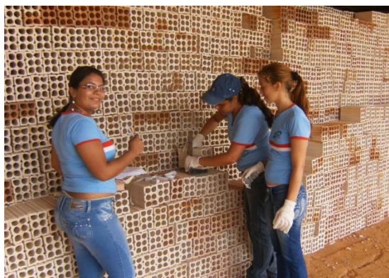
Figura 16 - Ensaio feito do desvio em relação ao esquadro
