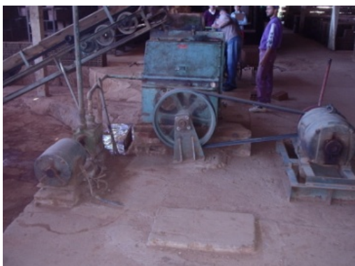
Figura 8 - Maromba ou extrusora.
