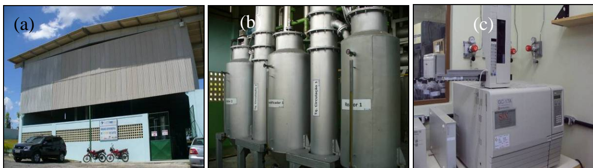
Figura 1. Usina piloto de produção de biodiesel (a). Etapa reacional (b). GC do laboratório (c).
