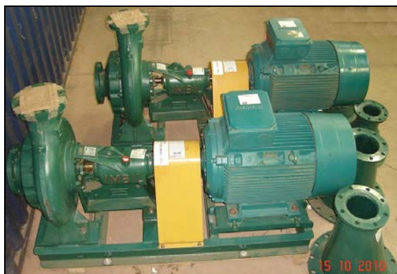
Figura 6: Novos conjuntos motobomba de alto rendimento de 100 CV.
