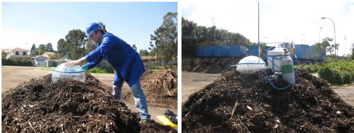
Figura 5: Amostragem com câmara de fluxo sobre a leira de compostagem.
