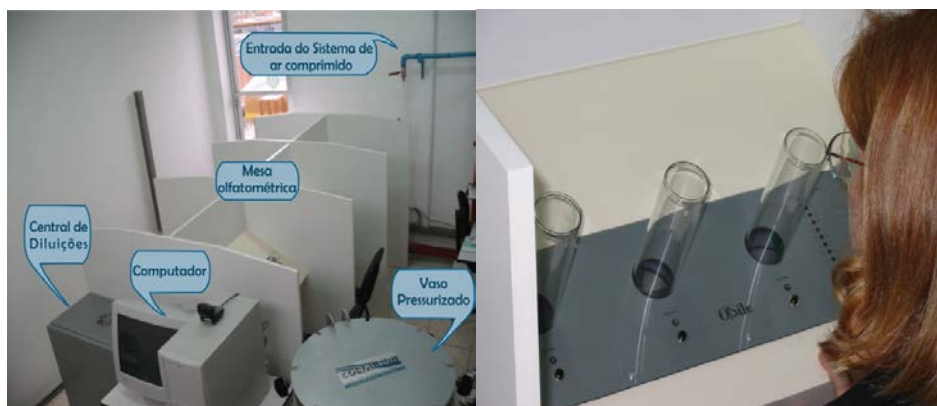
Figura 4: Componentes do sistema do olfatômetro ODILE 2000 e saídas de ar propostas a um jurado.
