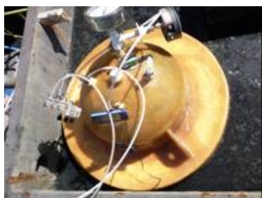
Figura 1 - Câmara de fluxo posicionada sobre a superfície líquida do decantador do reator UASB.
