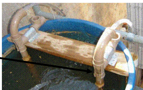
Figura 2 - Foto do sistema controle de vazão por sifonamento
