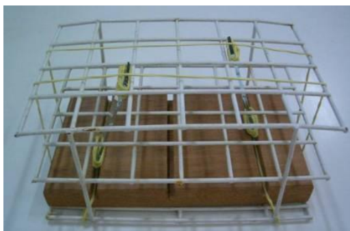
Figura 4 - Conjunto utilizado como substrato artificial para coleta das algas perifíticas.
