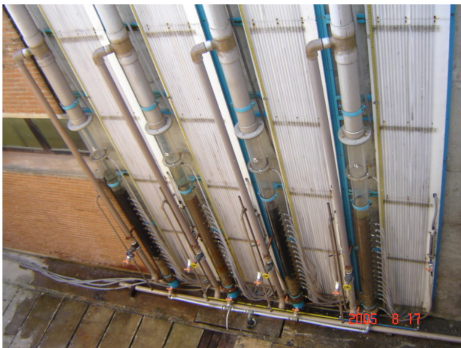
Figura 1: Detalhe dos 4 filtros de alta taxa e fluxo descendente em escala piloto operados em paralelo.
