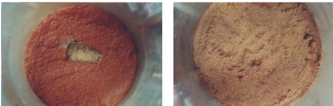
Figura 8 - Filtros-piloto durante e após a limpeza - Vista superior
