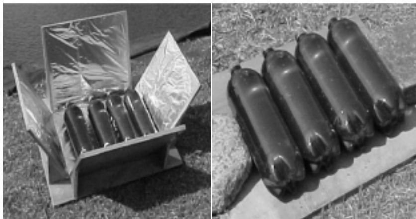
Figura 2 - Experimento em andamento: garrafas expostas ao sol com e sem a utilização do concentrador dos raios solares
